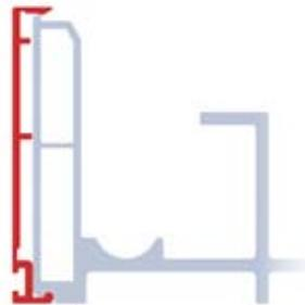
5) **Importante!** Posizionare la copertura frontale sul meccanismo in modo che fuoriesca lateralmente dello stesso valore **A**.
