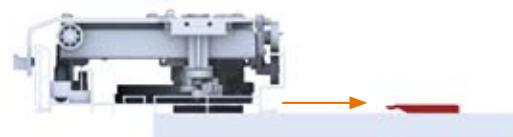
6) Den oberen Mechanismus am Oberteil anbringen (Abb. 8), wobei darauf zu achten ist, dass er korrekt an den Clips eingehängt wird (Abb. 9A und 9B).
