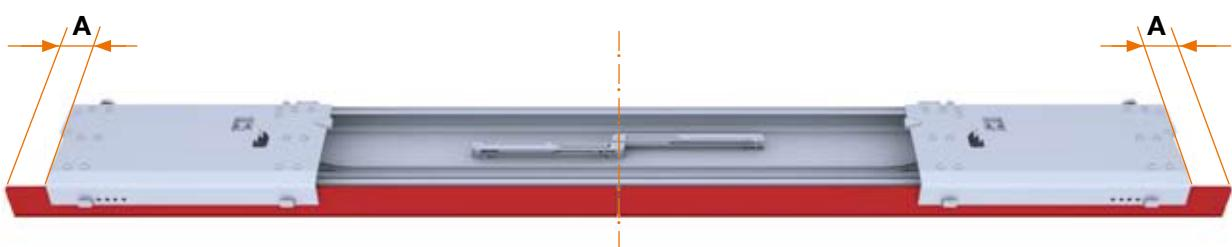
6) Applicare il meccanismo superiore sul cielo (Fig. 8) facendo attenzione che si agganci correttamente alle clip (Fig. 9A e 9B).
