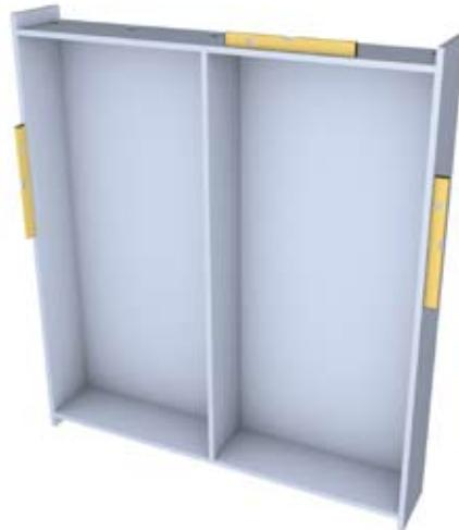
3) Applicare il meccanismo superiore sul cielo (Fig. 3) facendo attenzione che siagganci correttamente alle clip (Fig. 4A e 4B).
