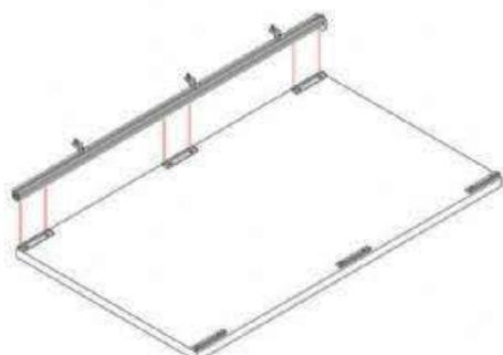
壁板固定器上的L邊治具移除後，即可將立柱安裝於背板上
