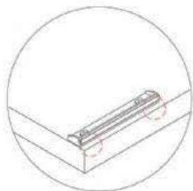
壁板固定器上有小小的L邊治具，直接對齊背板的邊緣，即為正確的位置和距離。螺絲固定完後，即可移除其L邊治具
